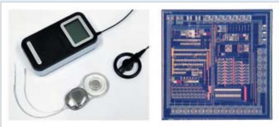
그림 4. 서울대학교 초미세생체전자시스템 연구센터와 (주)뉴로바이오텍이 공동개발한 인공와우 장치(좌)와 신경 자극칩 (우) (제공: (주)뉴로바이오텍)
